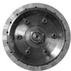
图 2 加压内冷却砂轮
