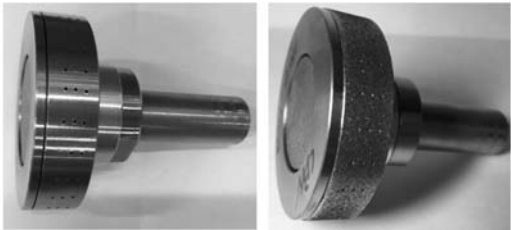
图 5 内润滑砂轮结构示意图
