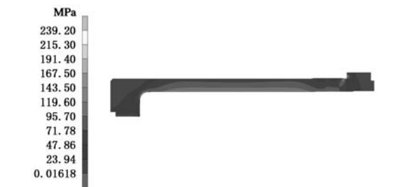
图 7 压力为 35 MPa 时的缸体等效应力云图
