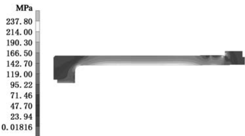
图 9 压力载荷为 68 MPa 时缸体的等效应力云图
