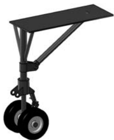
图 3 前起落架虚拟样机模型
