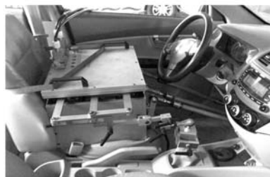
(a) 驾驶机器人在试验车辆上的安装图
