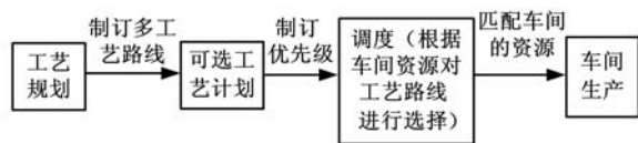
图 1 非线性工艺规划的基本原理图
