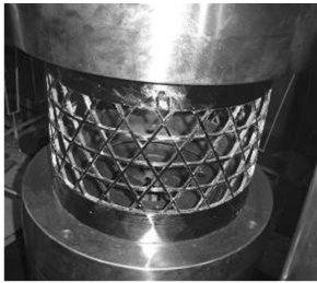
图 8 复合材料网格结构轴压加载图
