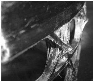
图 9 复合材料网格结构轴压破坏图
